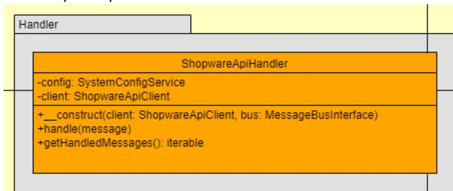
Der *ShopwareApiHandler* nimmt Anfragen aus der AMQP-Queue entgegen und leitet diese an den *ShopwareApiClient* weiter. Anschließend sendet er die Antwort, welche der Client empfangen hat in die Antwort-Queue des AMQP-Servers. Die Logik dieser Klasse ist minimal um Dependency-Injection für den Client möglichst leicht zu machen.
